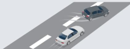
走行中の自車前方への割り込み車両を検出し、アラームでお知らせします。また設定により割り込み録画データとして記録することもできます。
