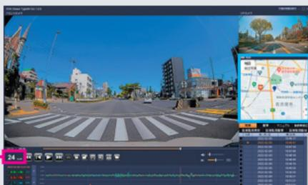
GPS搭載モデルでは自車の走行速度や位置情報を録画データと共に記録します。また、日時情報もGPSにより自動で補正されるため、設定を行う必要がありません。弊社ホームページよりダウンロードできる専用ビューワソフトを使用すれば、自車の走行軌跡を地図上に表示することもできます。
