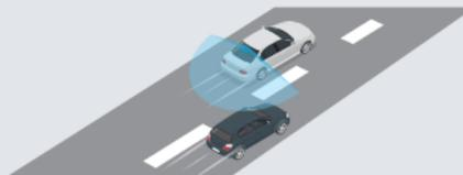
車両斜め後ろに接近する車両などを検出し、アラームでお知らせします。
