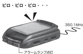
●取締り連絡無線（350.1MHz）を受信すると、アラームランプが速い点滅点灯しピロ・ピロ音で約3秒間警告します。
