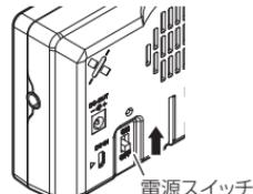
電源を入れた後、「SDカードの異常を検出しました。SDカードを確認してください。」とエラーが表示された場合、レーダーの電源をOFFにした後、microSDカードを抜差しし、再度電源を入れてください。再度同じエラーが表示される場合は、弊社サービスセンターまでご相談ください。
